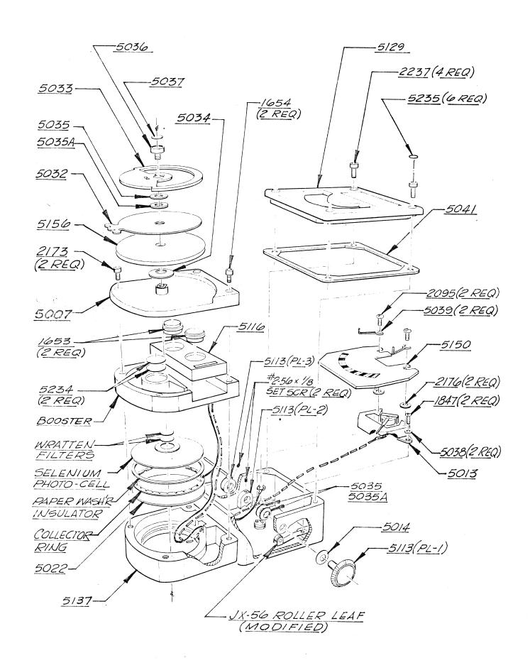
FIGURE III EXPOSURE METER "COMBI-500" (ORIGINAL MODEL W/POINTER LOCK)
