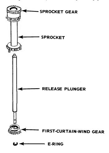
FIGURE 29 SPROCKET AND RELEASE PLUNGER
